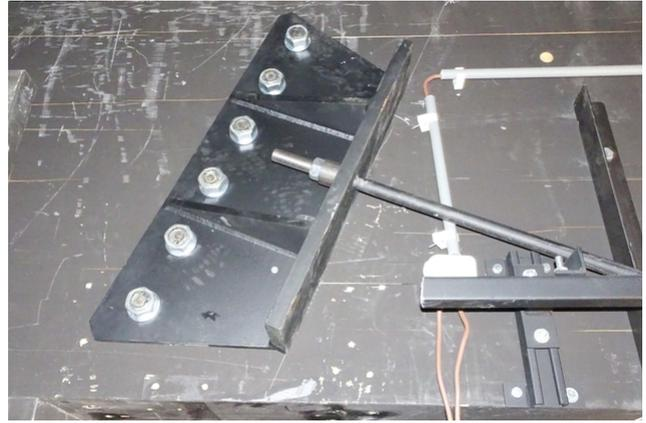
Befestigungen der Zugstangen mittels Stahlplatte
