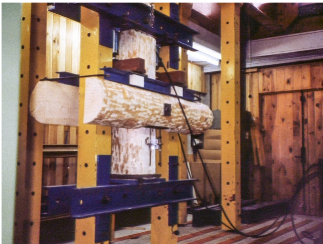
Entwicklung und Prüfung des Anschlussteils Zange-Pfosten...
