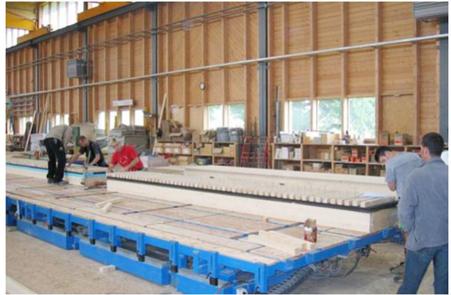
Fabrication d'éléments de toiture
